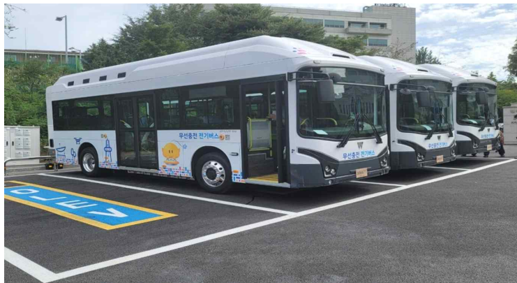
<그림> 150kW급 정차 중 무선 충전시스템을 탑재한 전기 버스
